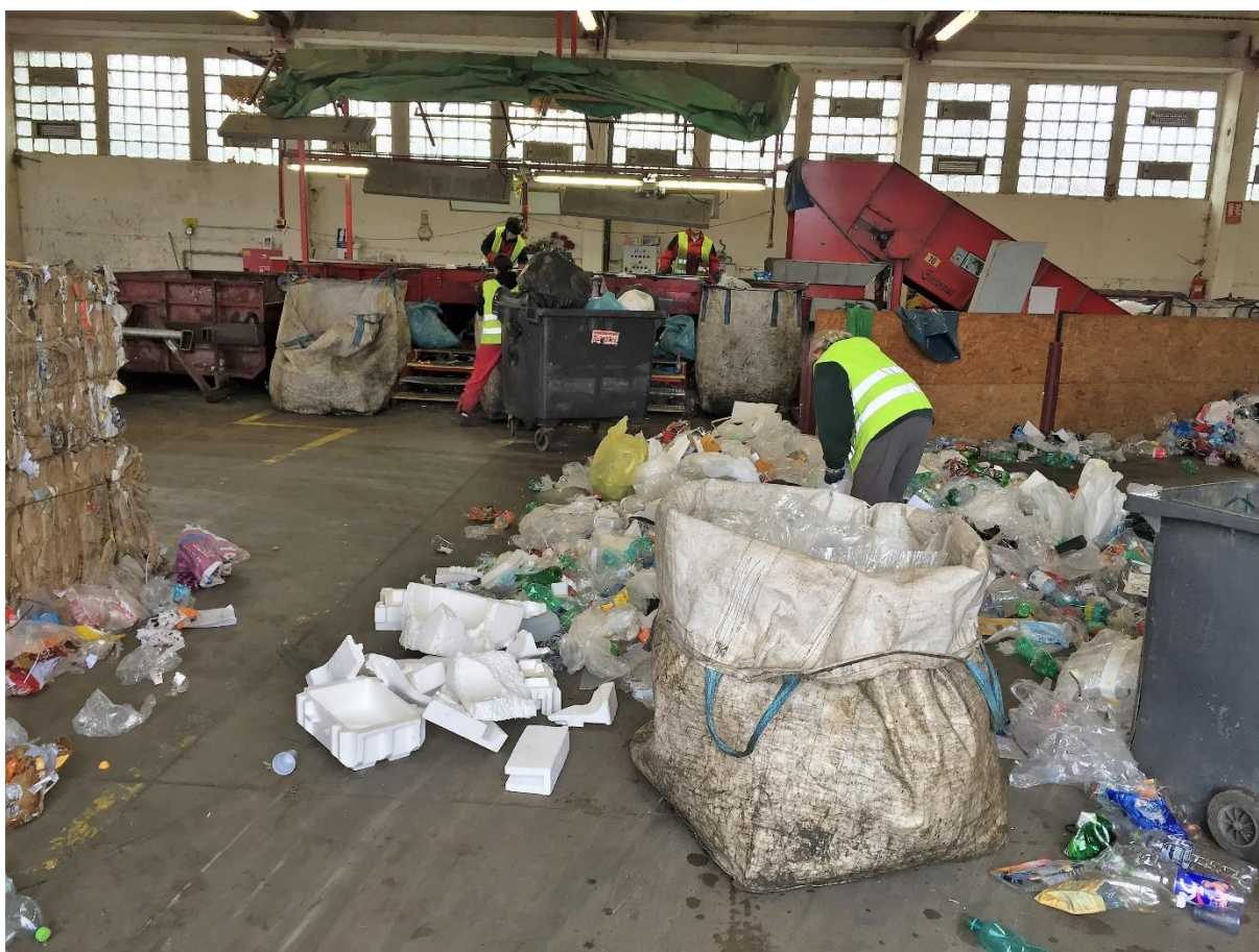
Obrázek 5 Příklad provedení třídící linky s pásem a tříděním do big-bagů
