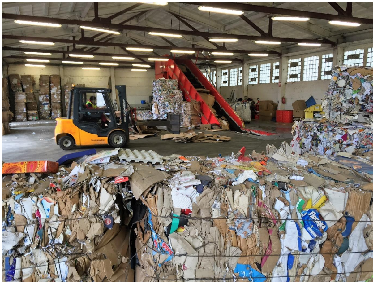
Obrázek 4 Příklad provedení kontinuálního lisu; třídící linka vyžaduje značný vnitřní manipulační prostor
