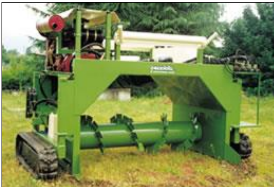
Obrázek 10 Samojízdný překopávač (např. PEZZOLATO PRS 2500)
