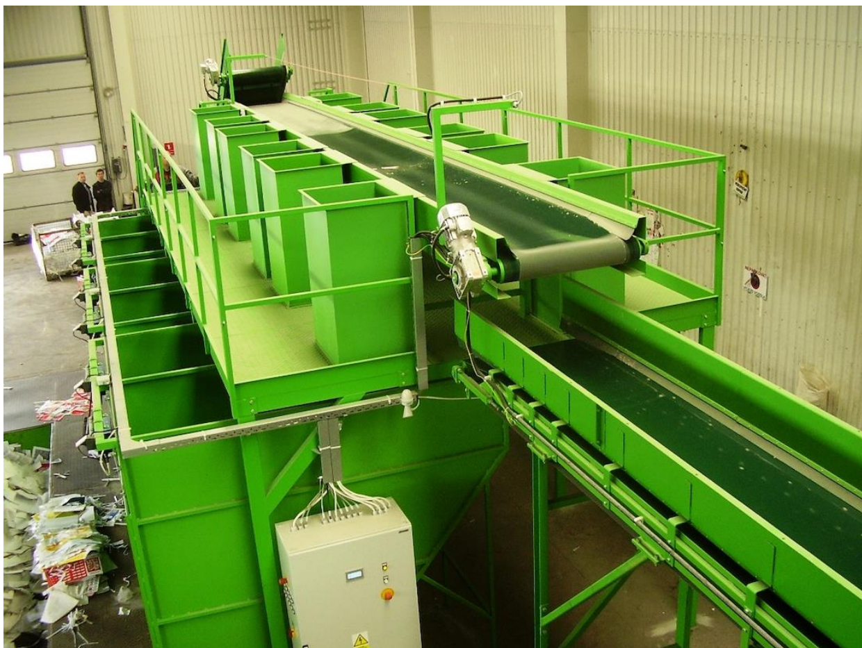
Obrázek 7 Třídící plošina (nekrytá) s třídícím pásem a se shozy a zásobníky vyříděných složek a dopravníkem pro výmět (firma ODES s.r.o.)
