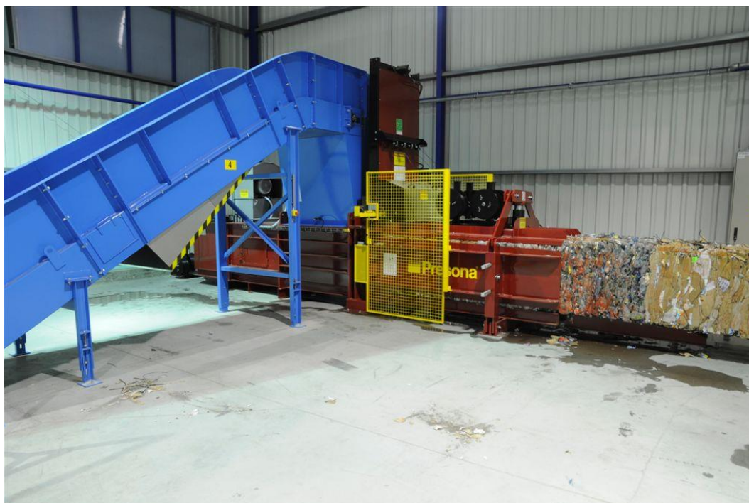
Obrázek 8 Vynášení dopravníků (od zásobníku vyříděných složek) a kontinuální lis (Presona)
