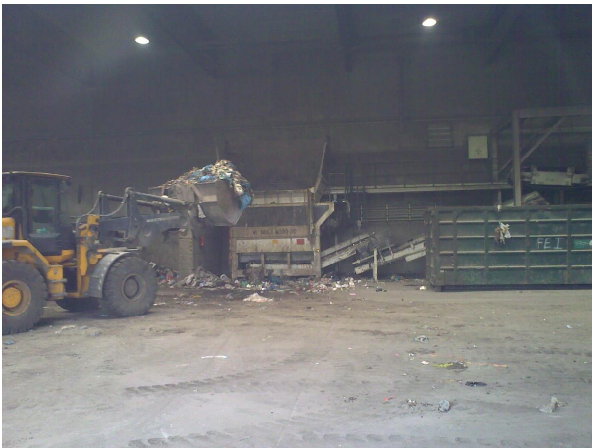
Obrázek 2 Příklad postupu přesunu SKO do pomaluběžného drtiče nakladačem
