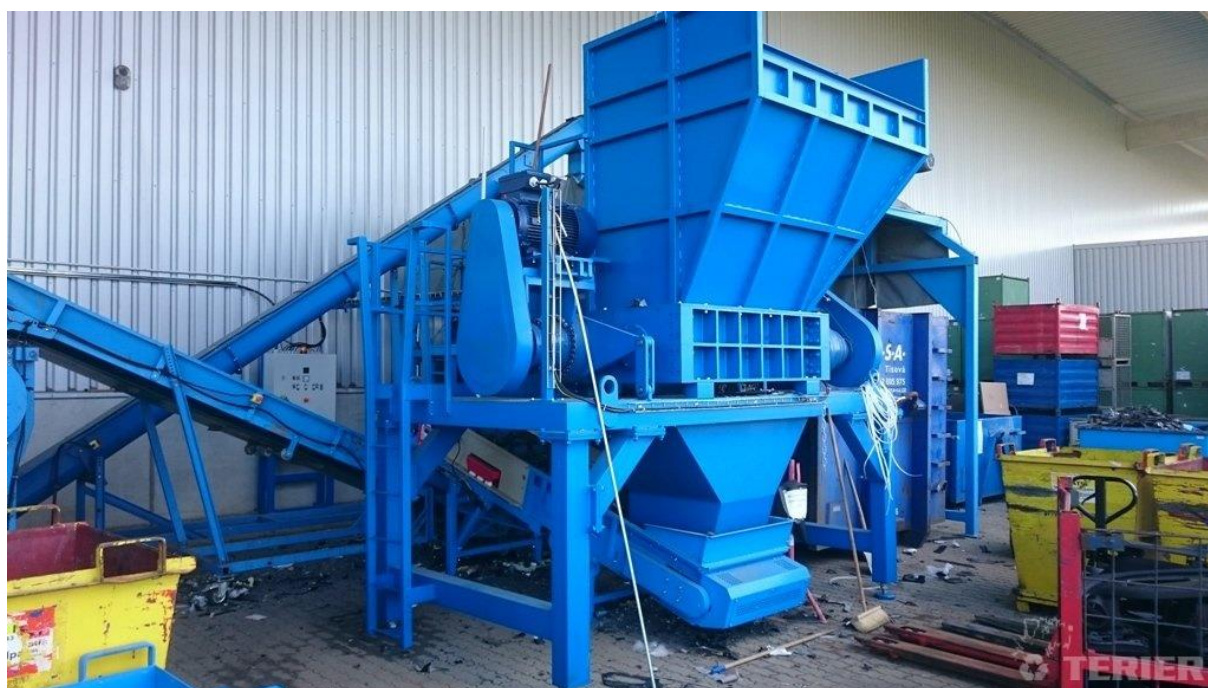
Obrázek 1 Pomaluběžný drtič – příklad provedení drtiče s násypkou (firma TERIER s.r.o.)
