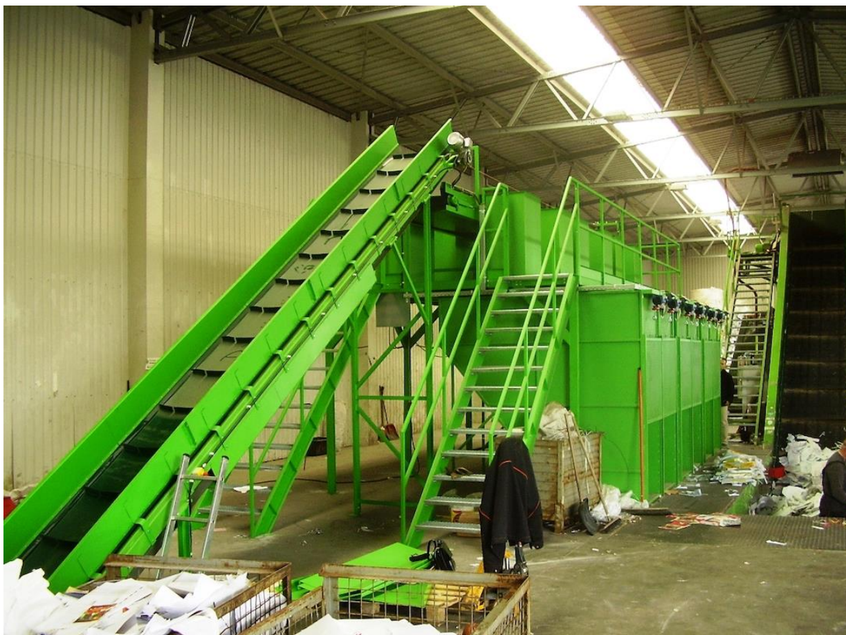
Obrázek 6 Třídící plošina (nekrytá) se shozy a zásobníky vytríděných složek a vynašecím dopravníkem na třídící pás a ke kontinuálnímu lisu (firma ODES s.r.o.)
