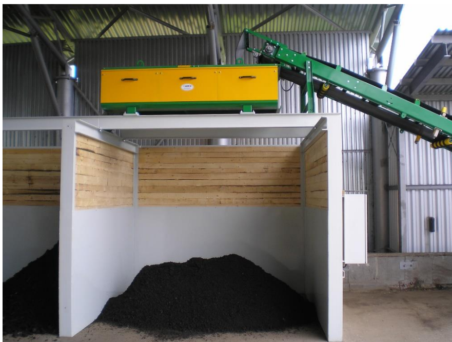
Obrázek 12 Hvězdicový separátor kompostu (výkon cca 25 m 3 /hod.)
