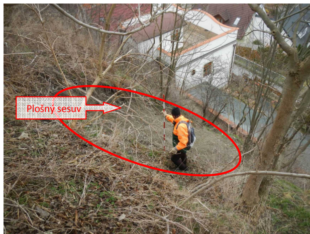
Mělký plošný sesuv nad domem čp.79: čelní pohled (vlevo) / pohled shora (vpravo)
