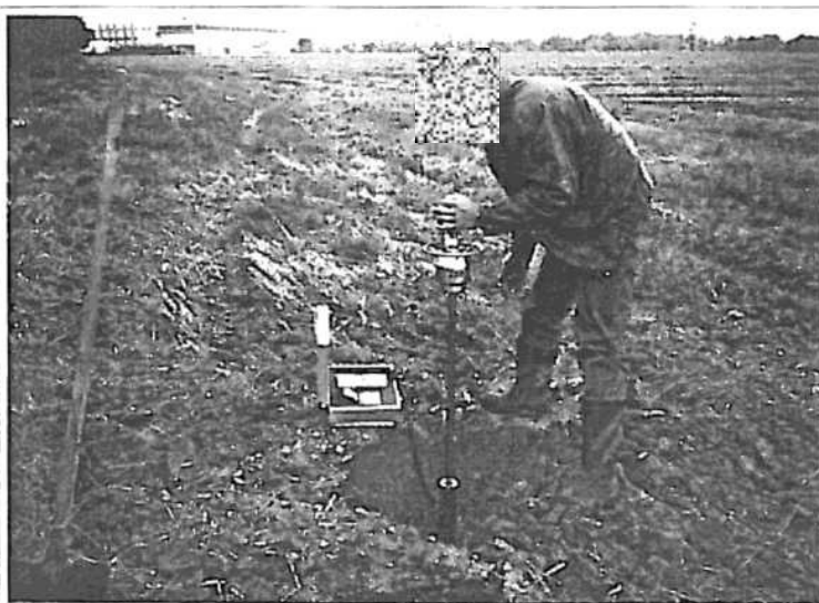
Foto č.3. Terénní zkouška lehkou dynamickou deskou LDD 100
