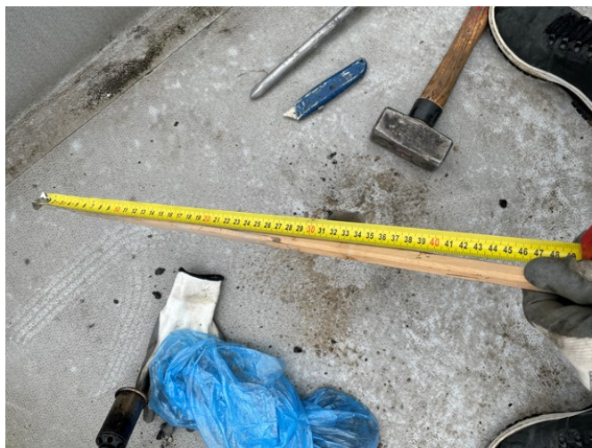
foto /8/ Tloušťka vyrovnávací betonové vrstvy v sondě S2
