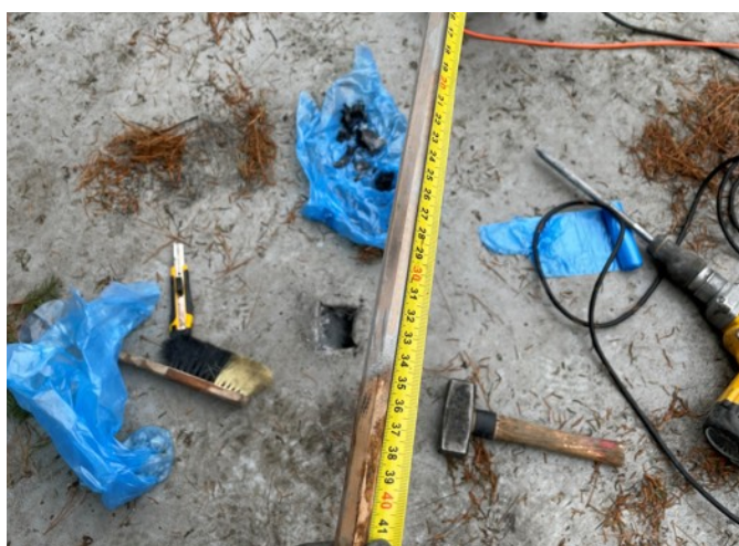
foto /6/ Tloušťka spádové vrstvy z pórabetonu v sondě S3
